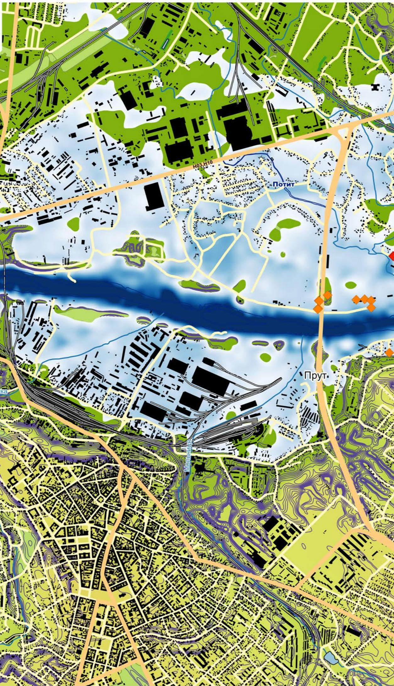
Схема моделювання повеневих та дощових підтоплень
